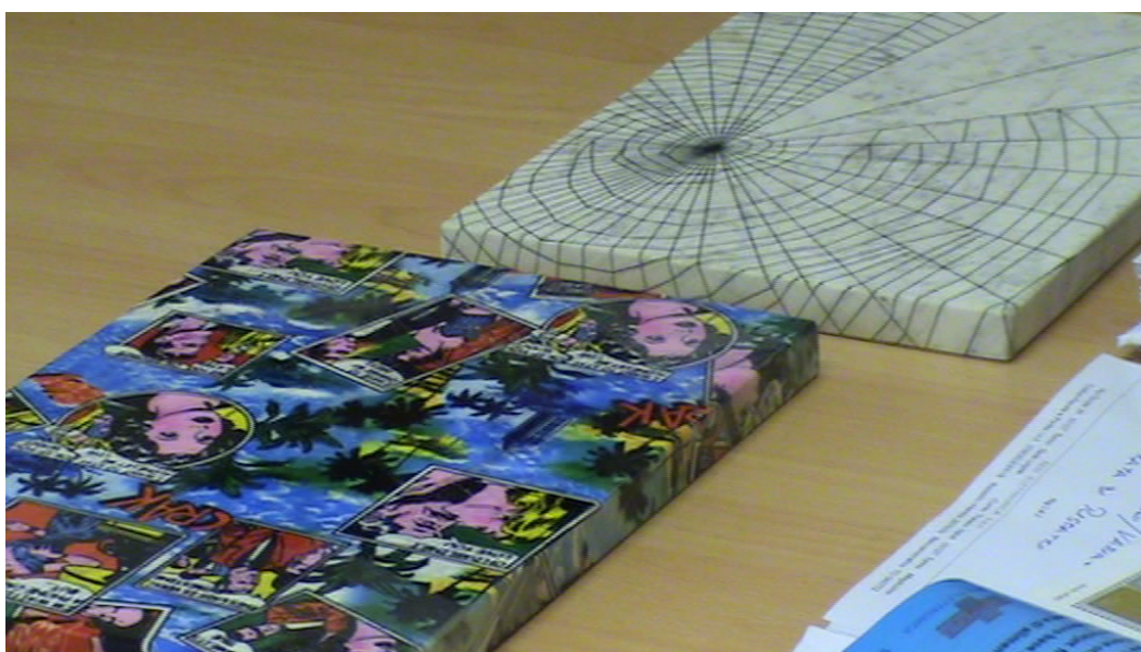
Illustration 3.7: Prove di qualità di stampa. Menphis, sublimazione: trasparenza.
