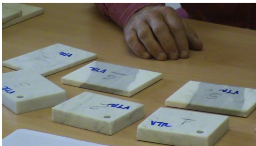
Illustration 3.12: Prove preliminari di adesione delle vernici.
